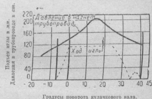
Фиг. 7. Кривая давлений и подъем иглы при повторном открытии иглы.
