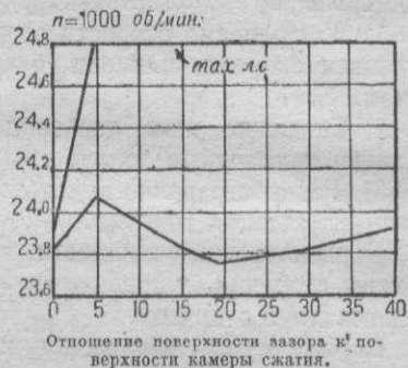
Фиг. 3. Потеря мощности от изменения поверхности «зазора в головке» при бездетонационной работе.
