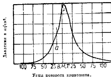
Фиг. 9. Диаграмма двухтактного дизель-мотора при различных периодах впрыскивания.
