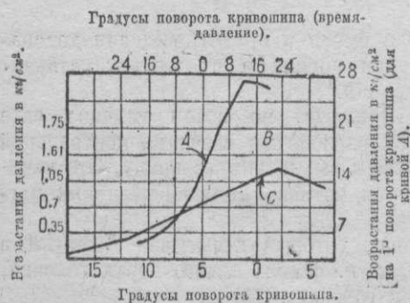
Фиг. 7. Кривые возрастания давления Дженуей, дающие мягкую работу мотора.
