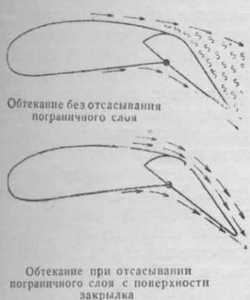
Обтекание при отсасывании пограничного слоя с поверхности закрылка
