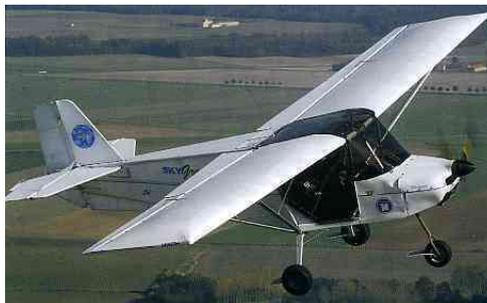
Appareil biplace côte à côte à Train Tricycle Fixe, à ailes hautes et empennage monodérive classique
