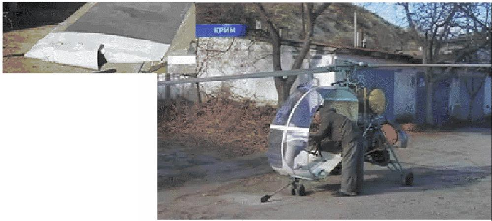
Газогенератор двигателя ГТД-3Ф вертолета Ка-25 (демонтирована силовая – свободная – турбина и противопожарный кожух). Отбор воздуха – из-за осцецентробежного компрессора
